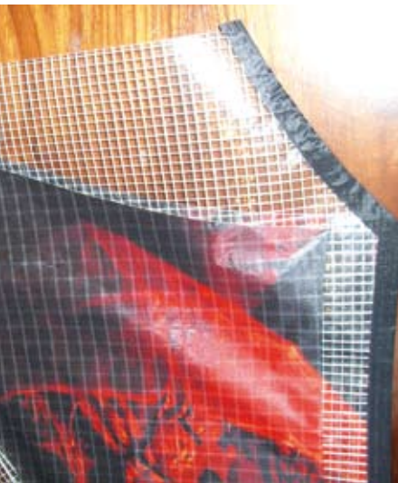
Viel dehnungsarmes Mylar wird verbaut
