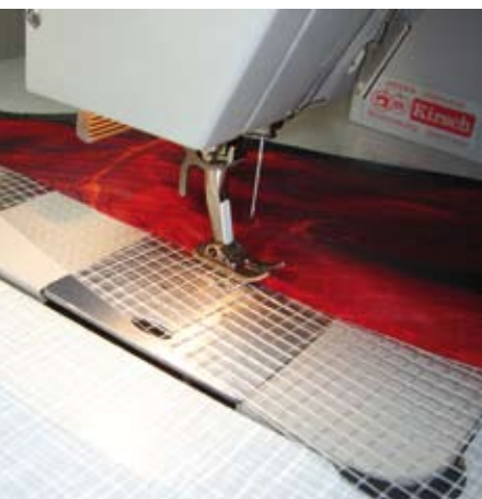
Alles wird ohne unnötige Überstände mit Segelmachernähten zusammengefügt
