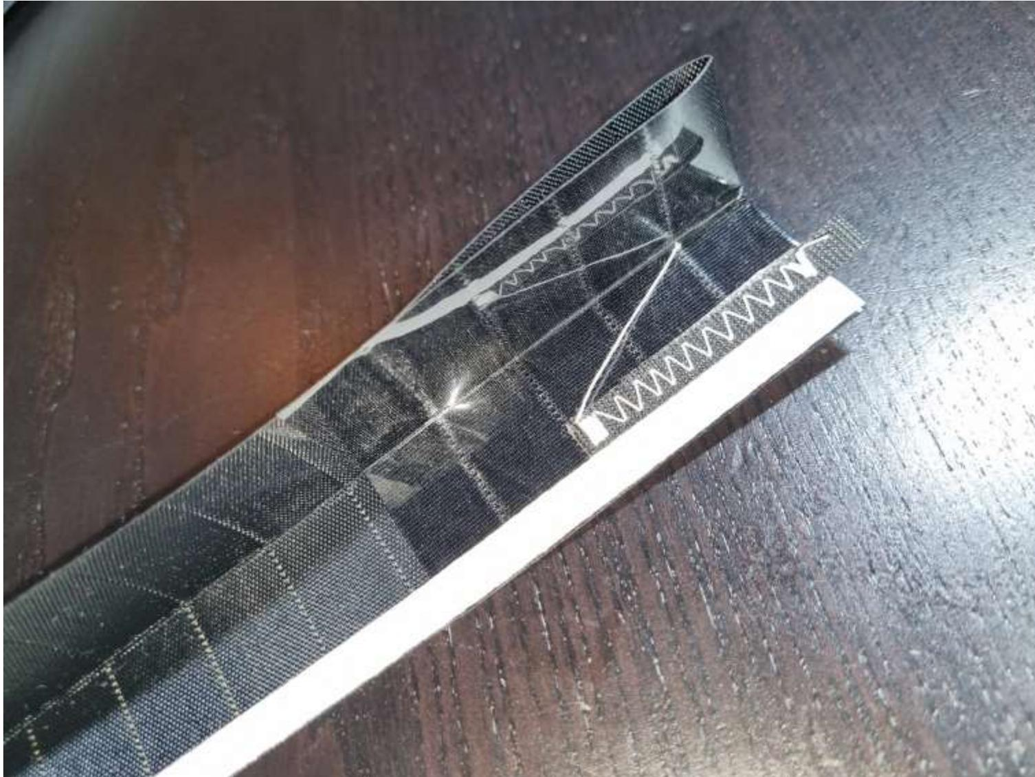
Annähen der LK-Taschen, Schlaufe zur Abspannung auf der Vorderseite des Segels, Segel bündig in Tasche gelegt
