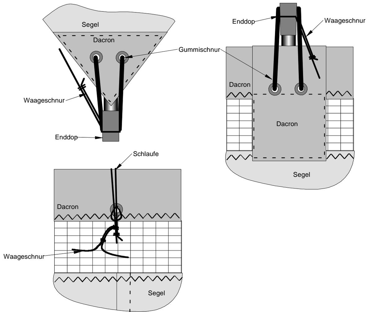
Alle nicht bemaßten Schlaufen haben eine Länge von ca. 80 mm, die Maße der äußeren Schenkel, die am Gestänge befestigt werden sind incl. Schlaufe zu messen.
